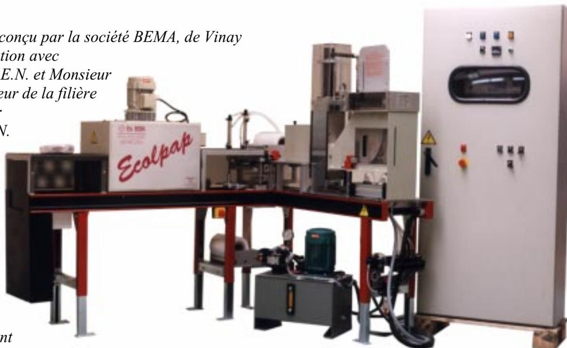
Ce système industriel de production est prévu pour servir de support permettant d'initier un nombre important de situations de maintenance pour les formations préparant au B.E.P. et au BAC.PRO. M.S.M.A.
